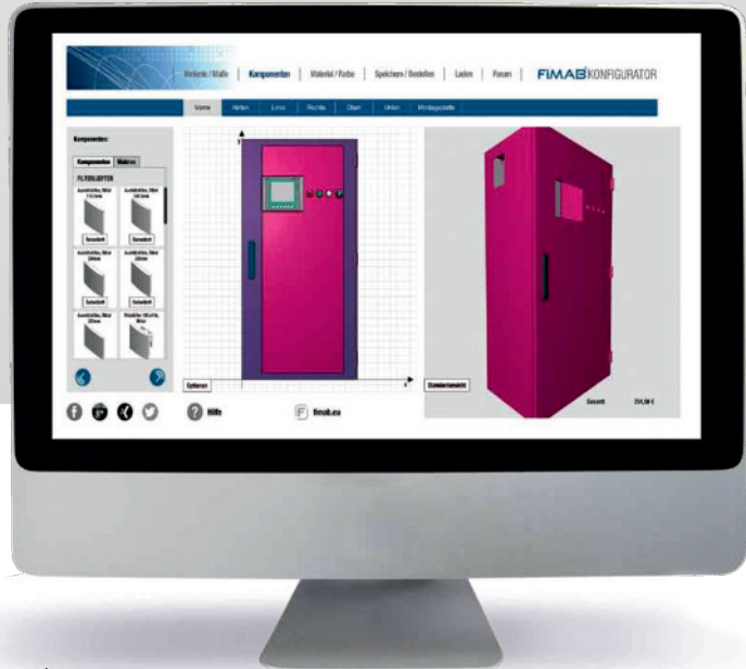
Bild 3 | Per Drag-&-Drop können die Komponenten millimetergenau im Schrank platziert werden.
