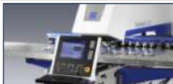
Wenn es auf höchste Produktivität im Zuschnitt gepaart mit einer großen Fertigungstiefe an Folgeprozessen geht, führt kein Weg am Stanzen vorbei. Neben dem eigentlichen Zuschnitt mit einem Arbeitsbereich von 2.500 x 1250 mm werden viele Anforderungen wie Endlossicken, Tiefziehen, Umformen, Entgraten und Gewindeformen voll automatisiert bis zu einer Blechdicke von 6.0mm in einem Arbeitsgang gleich mit realisiert.
